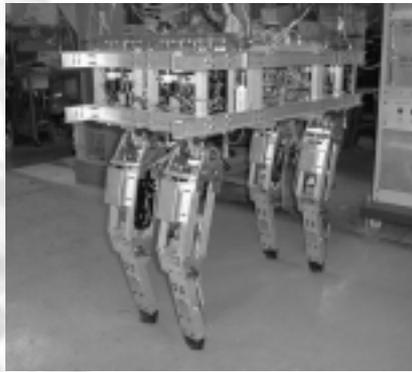
など前後左右方向に曲がる関節は、特殊な機構であるパラレルクランクスライダ機構(図1)によって、2個のモータの協調動作で駆動しています。
