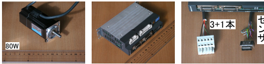
山洋製 モータ+センサ サーボアンプ 配線の例 C08 モータの基礎 Page. 17 基礎からのメカトロニクスセミナー
