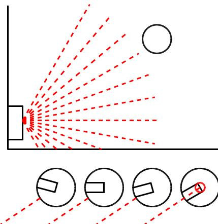
図13 充電ステーションからの誘導光とロボットの旋回による方向探知の例
