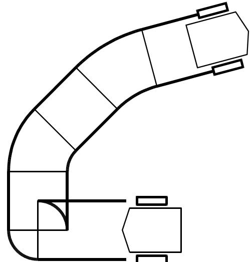
図8 区分的な直線や円弧の走行の積み重ねによって、ロボットは自由な経路を組み立てて走行できる。
