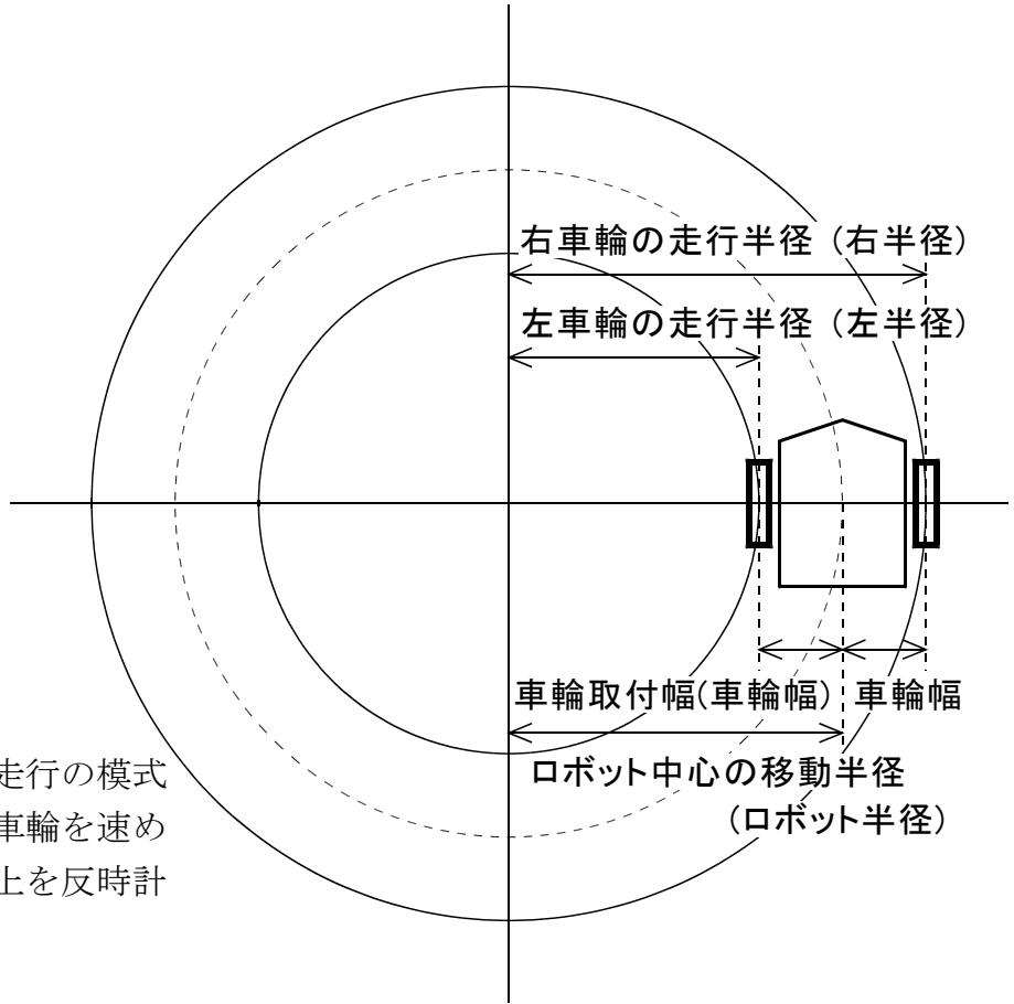
図6 ロボットの走行の模式図。左車輪より右車輪を速めにした場合は、円上を反時計回りに走行する。
