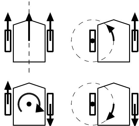
図5 対向2輪型ロボットの車輪回転と走行の方向
