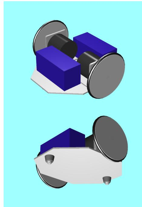
図4 対向2輪型ロボットの基本構造。独立して回転制御できる車輪を左右に備え、裏には補助的にキャスターを取り付けることが多い。
