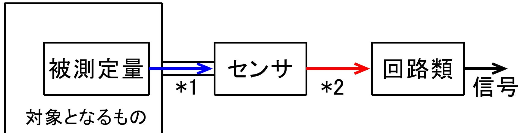
\*1 光、温度、圧力、速度、加速度、角速度、
