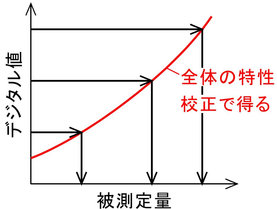
測定時 : 被測定量 → 変換特性 → デジタル
