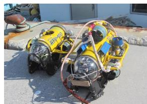
水中ロボット RTV-100 (引)Robonable
